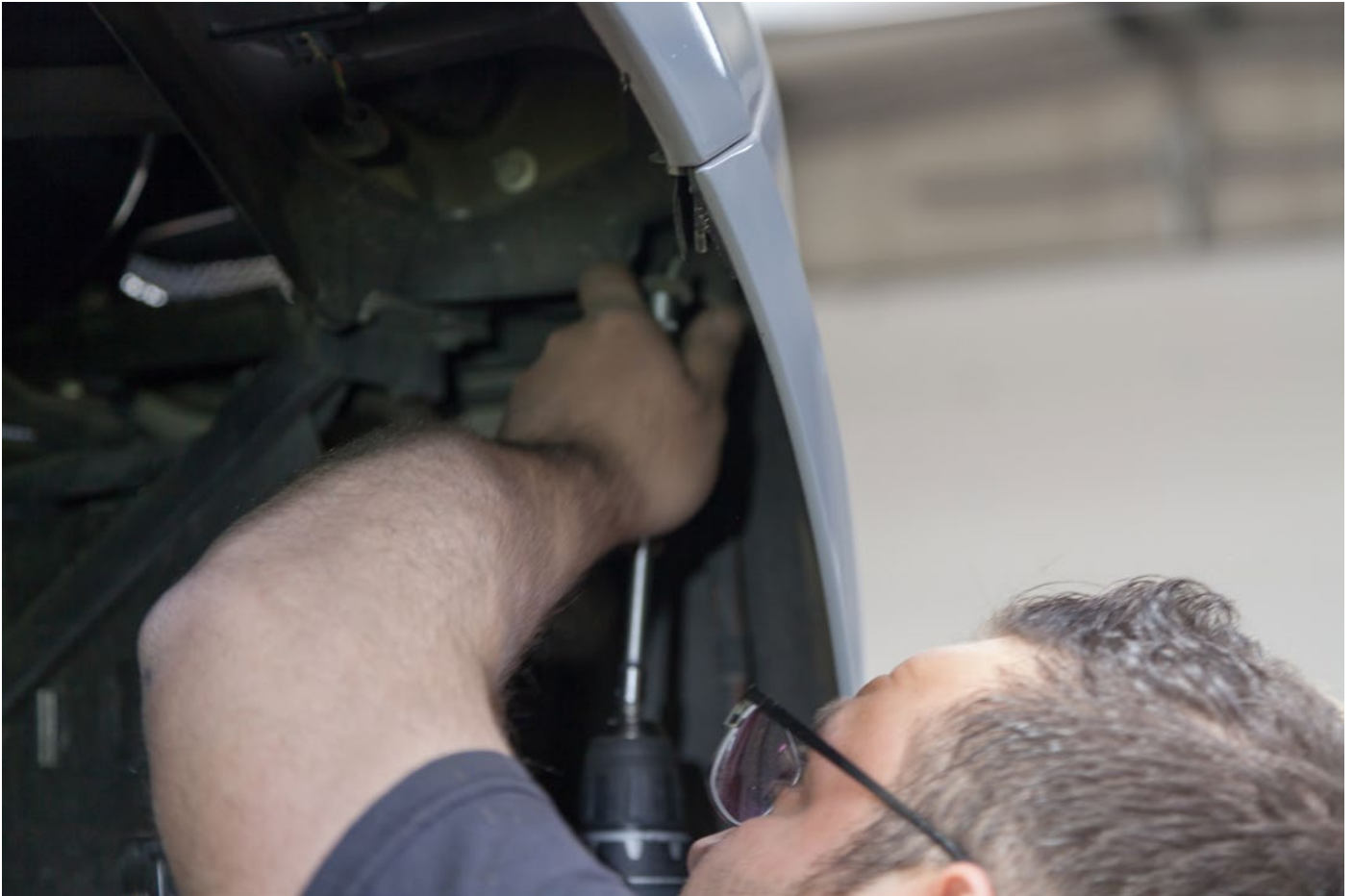
Stoßstange entfernen / remove the rear bumper
