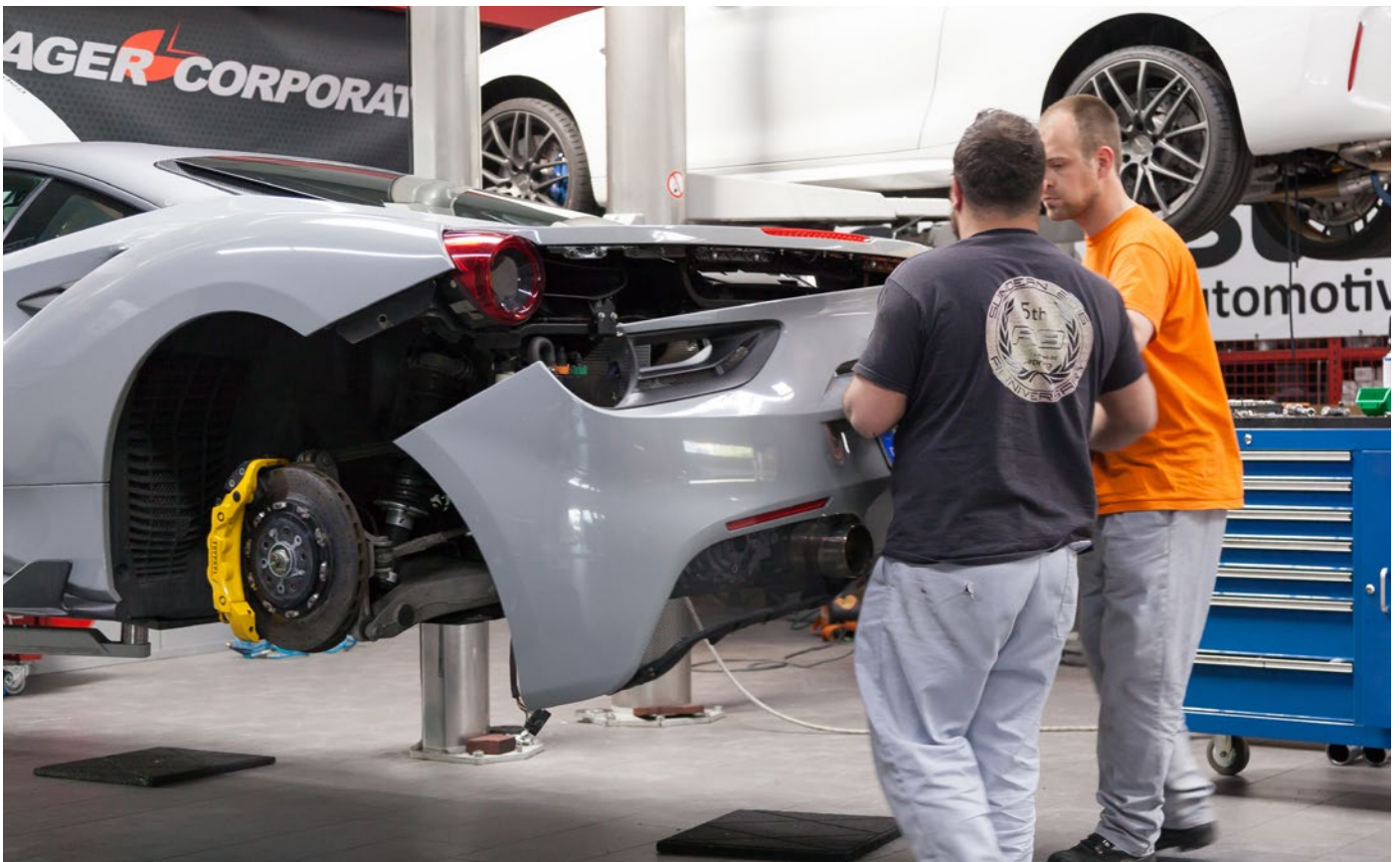
Stoßstange entfernen / remove the rear bumper
