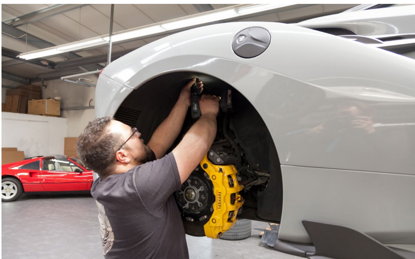
Radkastenauskleidungen entfernen / remove the wheel house liners
