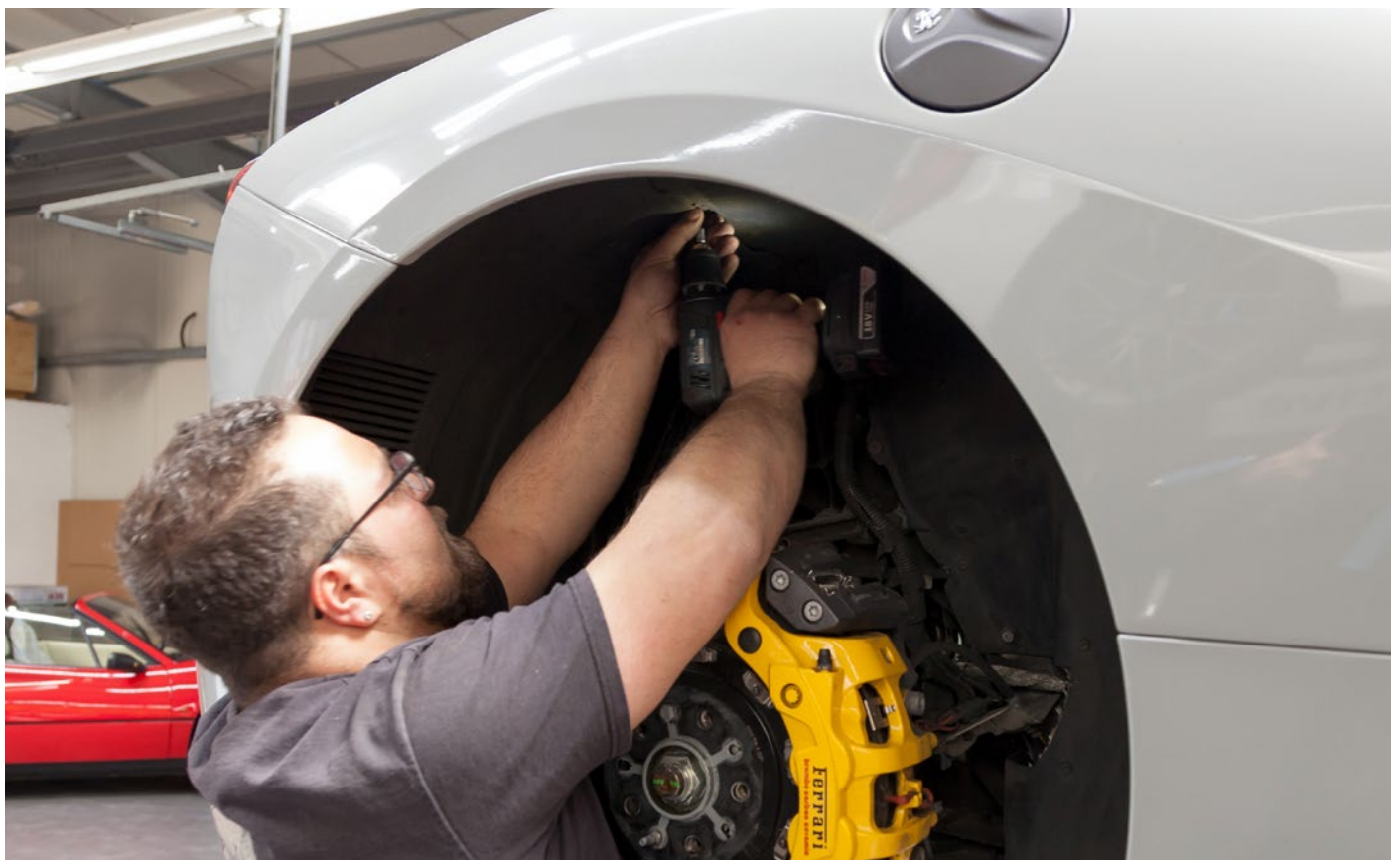
Radkastenauskleidungen wieder einbauen und Räder montieren / remount the wheel house liners and subsequently the wheels
