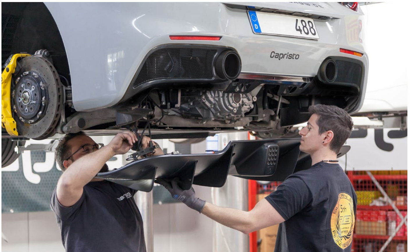
Die Stecker vom Diffusor wieder verbinden und Diffusor montieren / reconnect the plugs of the diffusor and remount it
