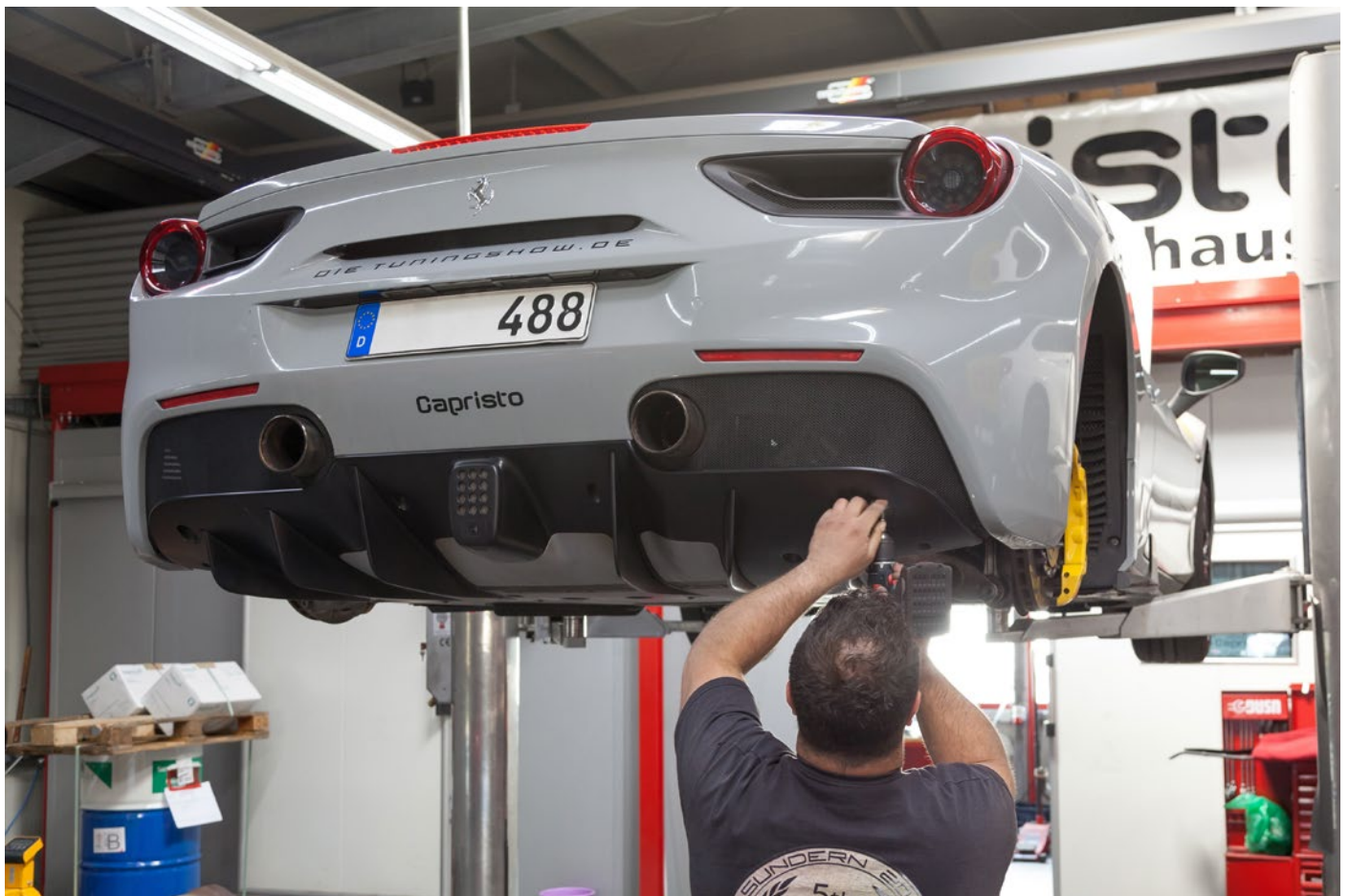
Diffusor abmontieren / remove the diffusor
