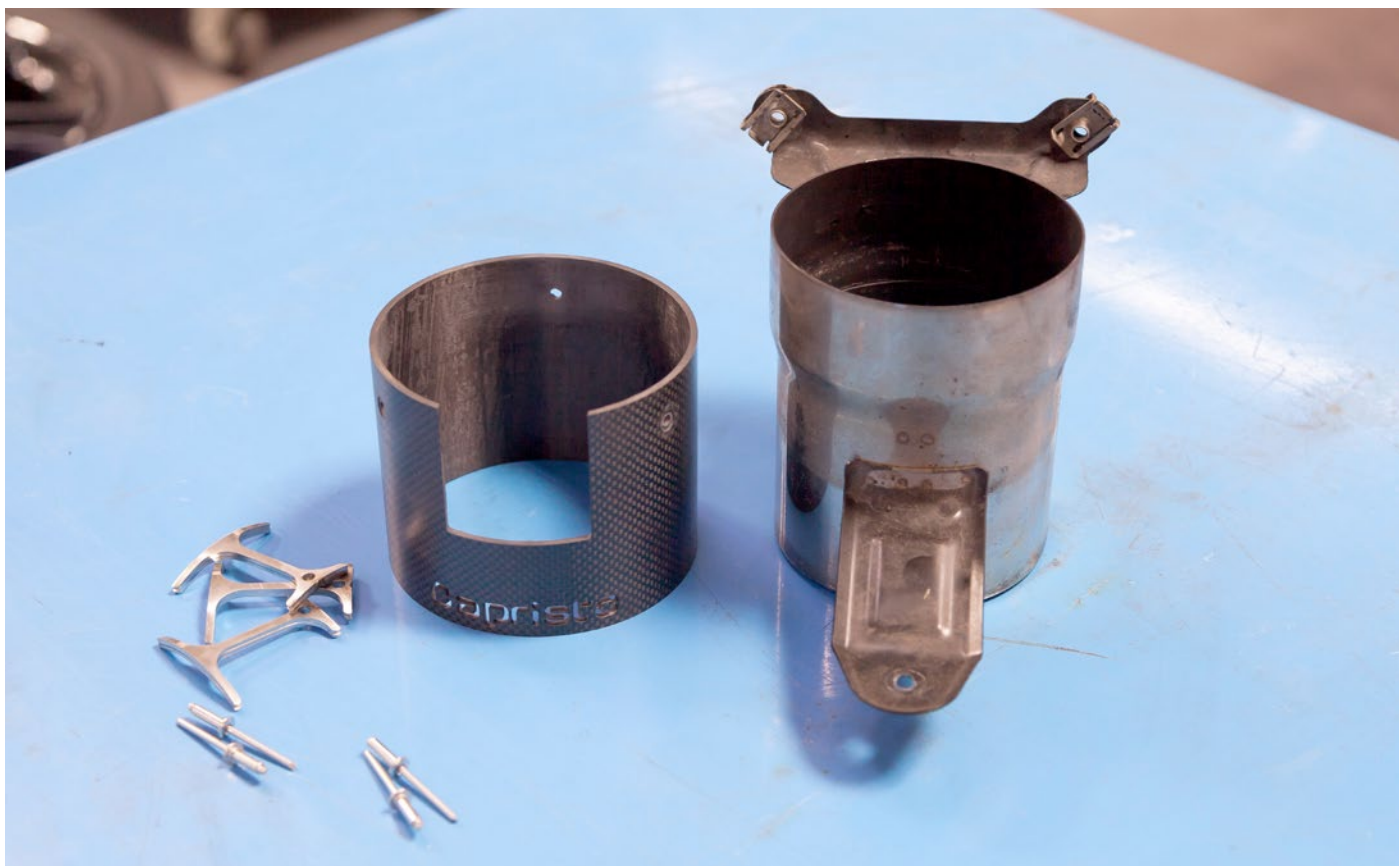
Vorbereiten der Endrohrereinheiten: 3x Nieten, 3x Abstandhalter pro Blende preparing the end pipe units: 3x rivets, 3x spacers per shell
